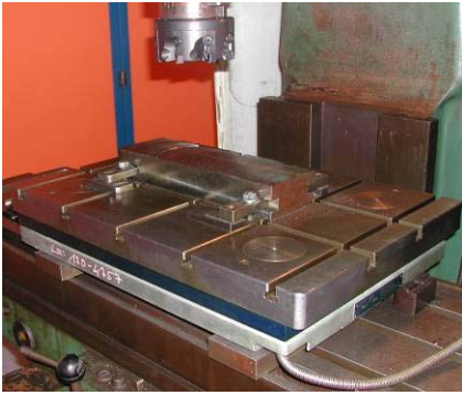
2. ábra KISTLER TYP928/B három komponensű erőmérő asztal KISTLER TYP9863/A töltéserősítő
