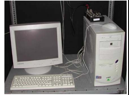
4. ábra National Instruments adatgyűjtő kártya, PCI-6013E (16 AI 200 k/s, 8 DIO, 2 TIO) LabVIEW Express 7.0, Adatfeldolgozó számítógép
