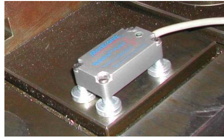
3. ábra Montronix USB-SPECTRA Pulse 3 komponensű rezgés és elmozdulás érzékelő, MONTRONIX IPM PULSE felügyeleti szoftver
