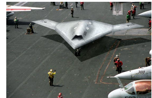
X-47B típusú harci UAV: Szárny fesztáv: 18,9 m Rep. csúcs magasság: 12 000 m Hatótávolság: 6500 km Precíziós bomba Levegő-föld rakéta
